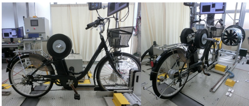
写真3. アシスト比率測定の様子
